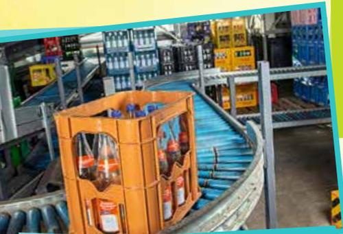
In diesem Raum werden die Flaschen und Getränkeboxen sortiert. Die Plastikflaschen werden zerdrückt. Das kannst du sogar hören, denn es knackt laut. Danach sind die Plastikflaschen fertig für das Recycling. Die Boxen mit den Glasflaschen gehen zurück an die Getränkehersteller.
