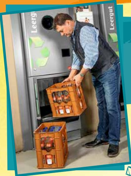
Der Leergutautomat hat vorne zwei Öffnungen für Flaschen und Getränkeboxen, einen kleinen Monitor und einen Knopf für den Bon. Einzelne Flaschen werden mit dem Boden zuerst oben in die runde Öffnung gesteckt. Unten kann man Getränkeboxen zurückgeben. Auf einem Fließband wird das Leergut in den Automaten gezogen.
